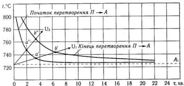
Рис. 92. Перетворення перліту П на аустеніт А при постійній температурі. Сталь з 0,86%С
